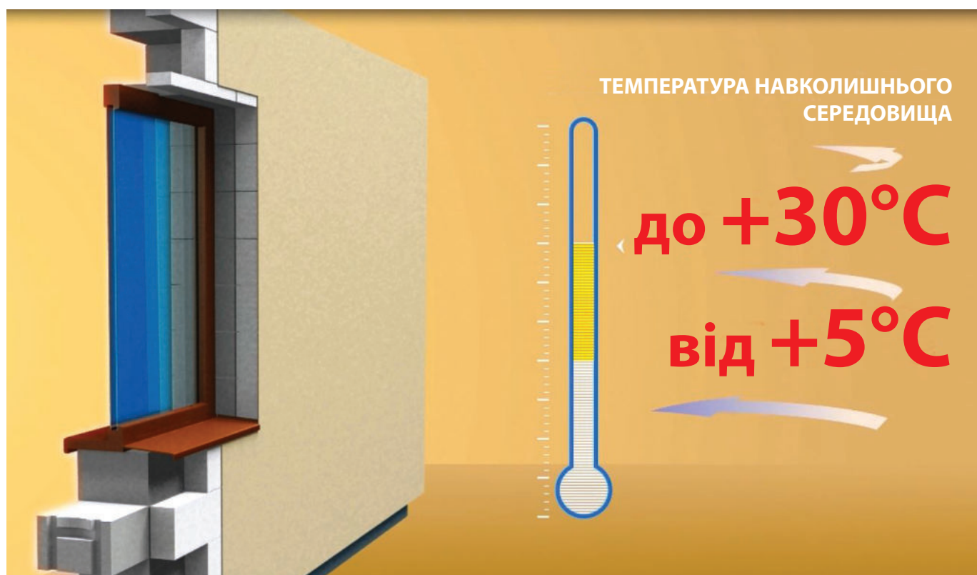
Мал. 7.7 Необхідні умови для виконання робіт з влаштування зовнішньої системи ізоляції AEROC Energy
