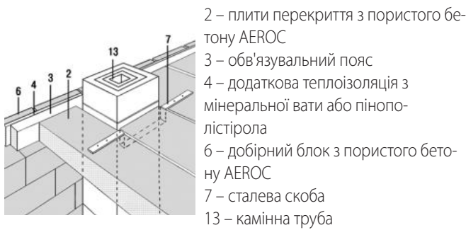
Влаштування отвору для монтажу димаря в перекриттях AEROC
